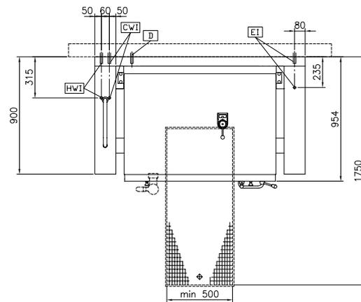
Brasiera elettrica basculante a pressione, 170 lt. (h), con funzione condensa vapore e sonda di temperatura, carico automatico acqua calda/fredda con rubinetto, doccetta, kit di chiusura posteriore.
